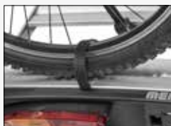
Cinghia scorrevole per assicurare rapidamente la ruota al portabici.
